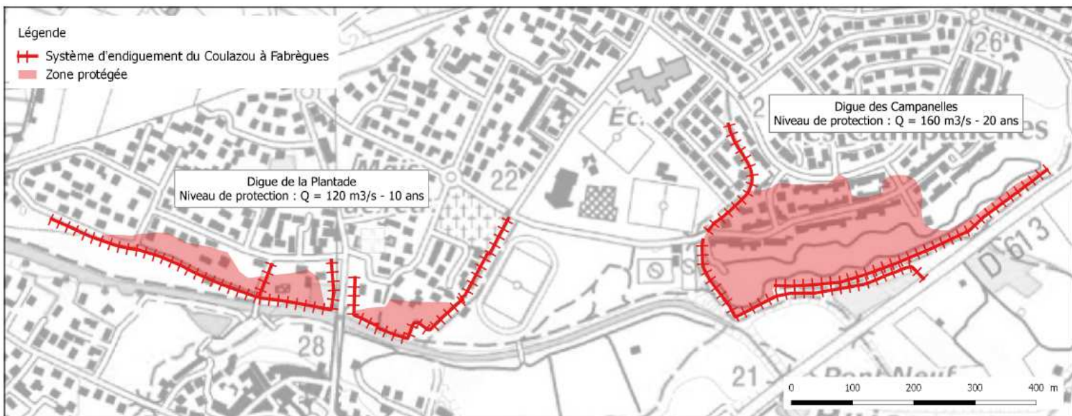
Figure 2 : Ouvrages existants (Source : Etude de dangers des digues du Coulazou – ANTEA – 2017)
